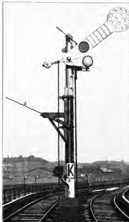
Fig. 823. Signalmast mit Streckenanschlag (a) zum Auslösen der Bremsen solcher Züge, die das »Halt«-Signal überfahren wollen.
