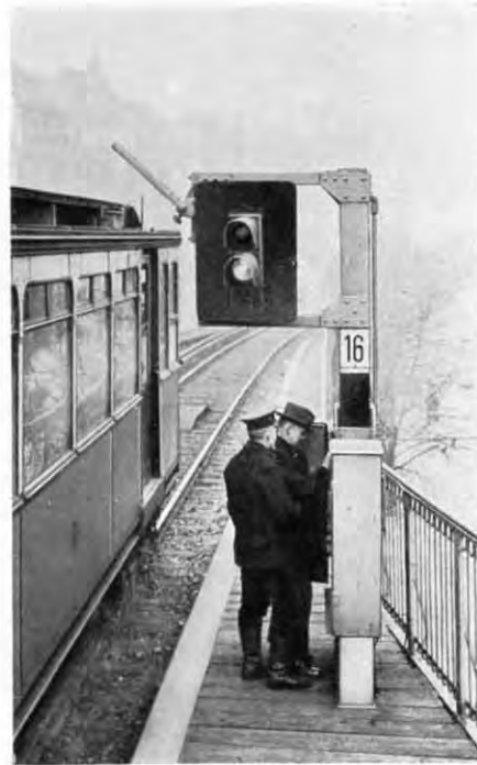
Abb. 19a. Signal und Fahrsperrre in Fahrtstellung.
